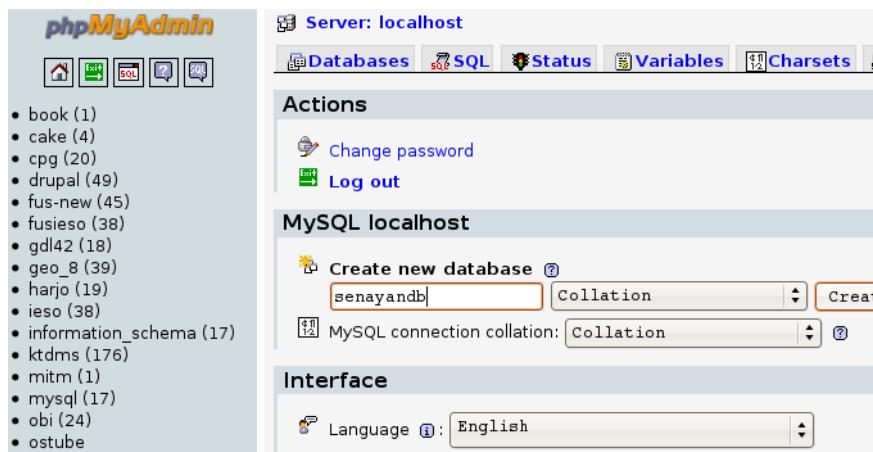
Gambar 2.5: Membuat database dengan bantuan phpMyAdmin
